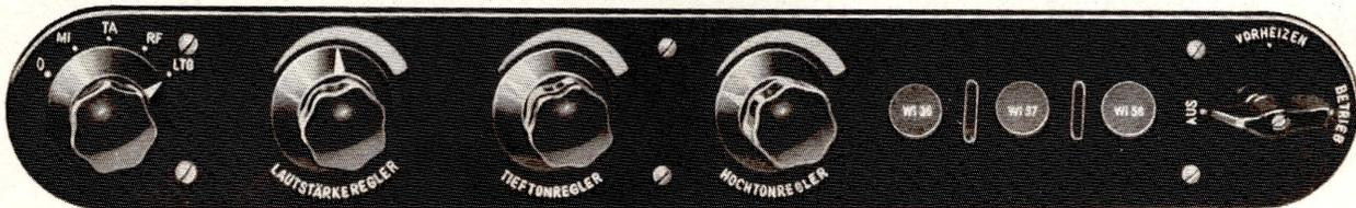
Zwischen der ersten und zweiten Röhrenstufe liegen zwei frequenzabhängige Netzwerke für die Höhen- und Tiefenregelung. Mit dem „Hochtonregler“ lassen sich die Höhen bei etwa 10 kHz um  $+12 \dots -14$  dB, mit dem „Tieftonregler“ die Tiefen bei etwa 50 Hz um  $+16 \dots -12$  dB regeln. Der Drehpunkt des Entzerrungsfächers liegt bei etwa 700 Hz. Die in einigen Fällen gewünschte Sattelform kann eingestellt werden.
