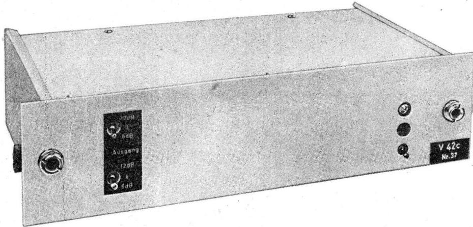
Der V 42c dient zur Verteilung der Modulation hinter dem Hauptverstärker auf zwei Wege und verhindert Rückwirkungen auf den Verzweigungspunkt. Der Ausgang ist von +6 auf +12 dB umschaltbar. Der V 42c enthält zwei gleiche voneinander unabhängige einstufige Verstärker mit getrennten Ein- und Ausgängen sowie einen gemeinsamen Netzteil. Die beiden Verstärker sind durch Gegenkopplung stabilisiert. Der V 42c hat größere Rücksprechdämpfung als der V 42b. Er ist als Einschubgerät ausgeführt.
