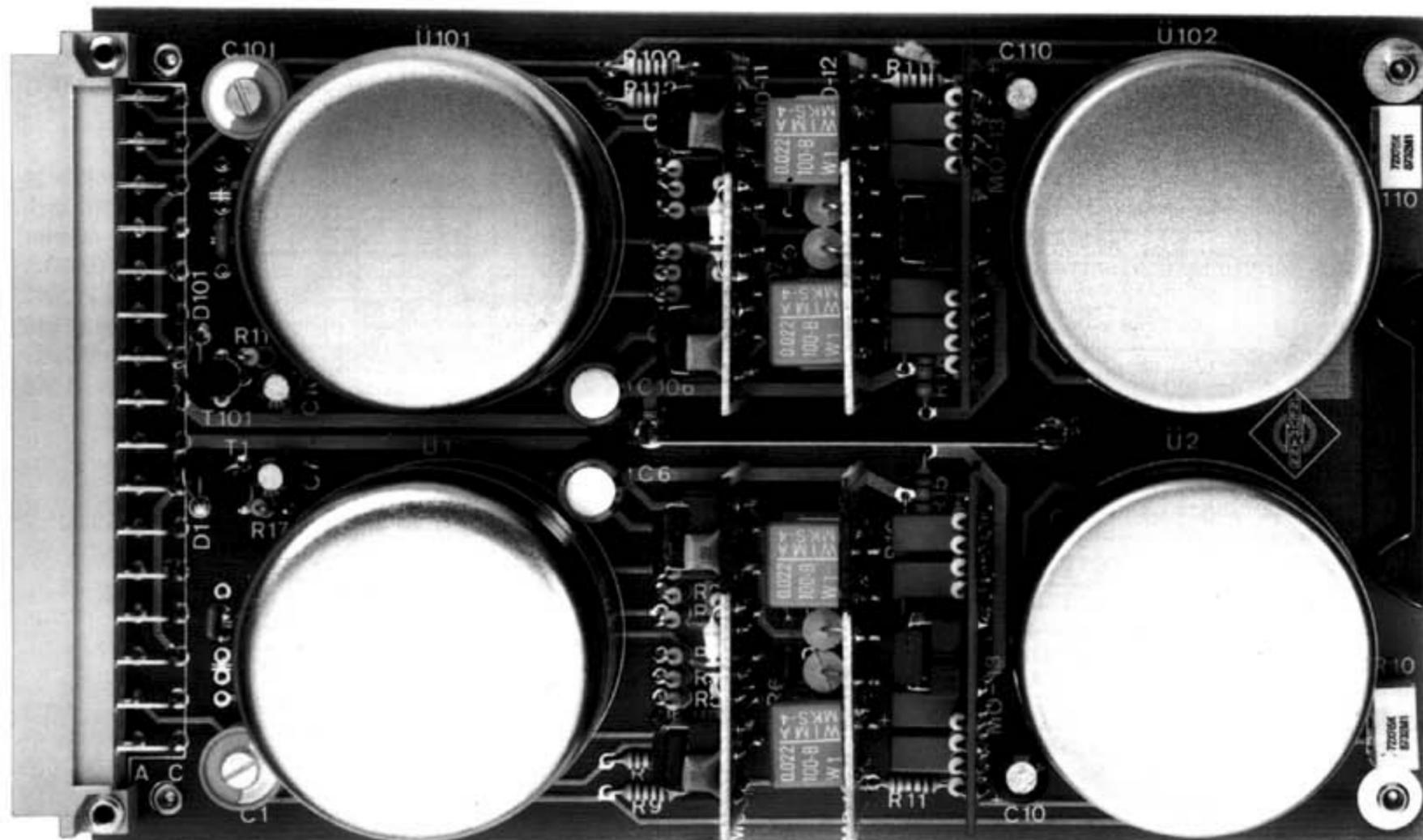
Der Duo-Sammelschienenverstärker V 475-2C ersetzt das Vorläufer-Modell V 475-2B. Er besitzt gegenüber diesem ein zusätzliches Hochpaßfilter.
