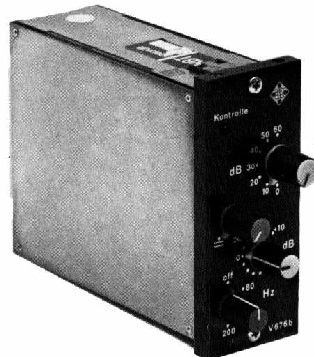
Der Aufbau gestattet den Zugang zu allen elektrischen Bauteilen nach Entfernen der beiden Seitenplatten ohne weitere Demontagen.
