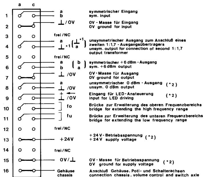
\*1 nur wechselspannungsmäßig  $\perp \rightarrow \frac{U_B}{2}$ !
